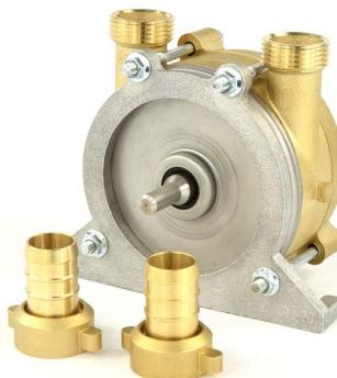
Pompa autoadescante predisposta per accoppiamento a trapani elettrici. La serie TR viene realizzata in ottone CB754S con albero in acciaio inox.
