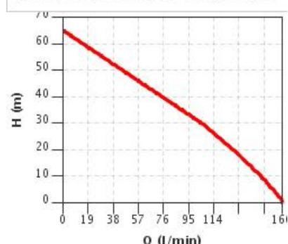
caratteristiche riferite al funzionamento con acqua a 20°
