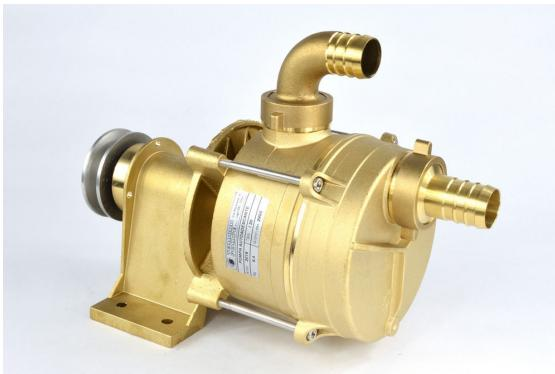
La migliore soluzione per l'aspirazione e il travaso di liquidi, grazie alla forte capacità di autoadescamento, alla possibilità di funzionamento anche con presenza discontinua del liquido in aspirazione e alla invertibilità del flusso. La serie I viene realizzata in ottone CB754S con albero in acciaio inox. Questa versione con supporto e puleggia consente un facile accoppiamento con qualsiasi motore. Per ogni applicazione occorre verificare l'idoneità e scegliere le guarnizioni opportune.
