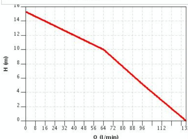
caratteristiche riferite al funzionamento con acqua a 20°
